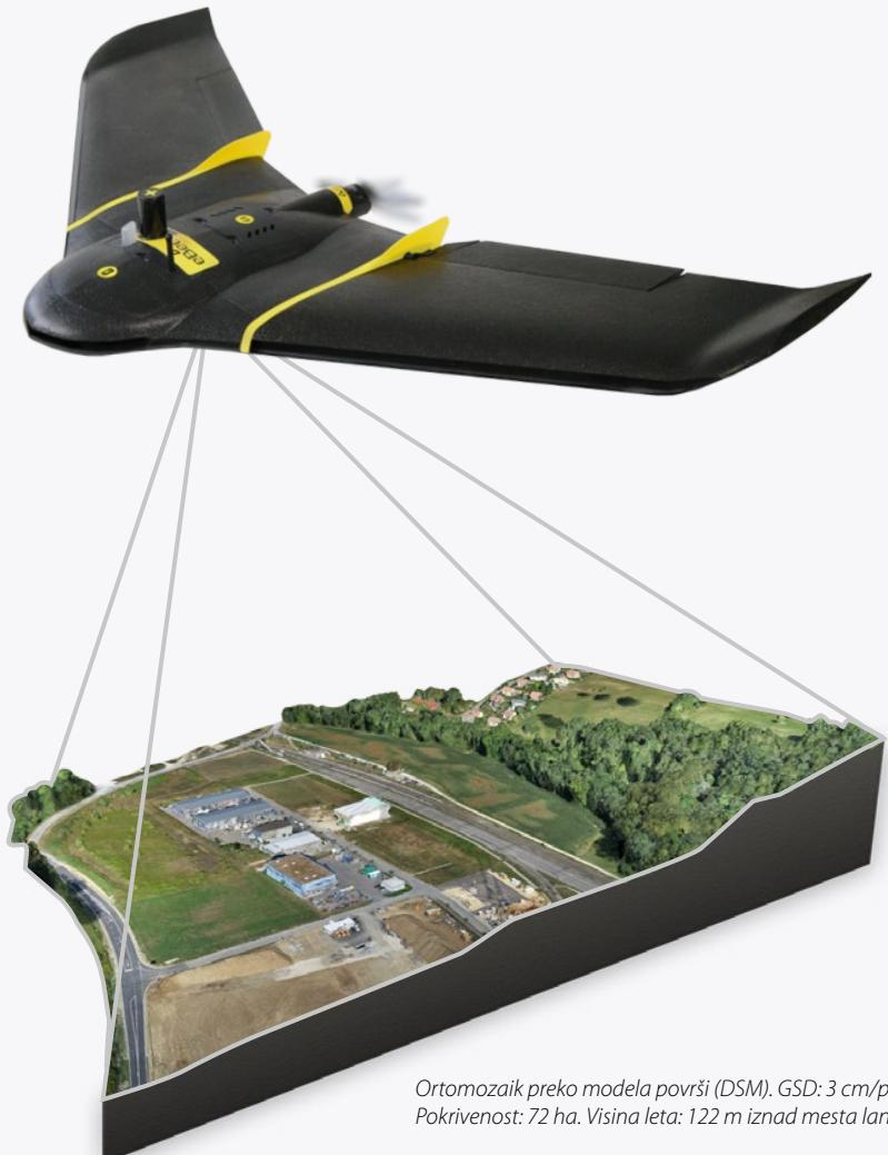
Ortomosaik preko modela površi (DSM). GSD: 3 cm/piksel.
