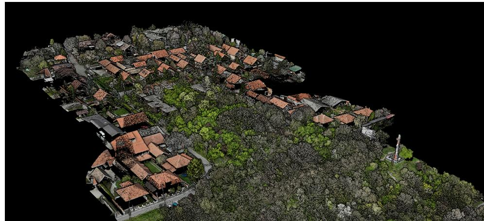
Skeniranje lidarom omogućuje uklanjanje svih objekata i vegetacije za kreiranje izvanrednih digitalnih modela terena.
