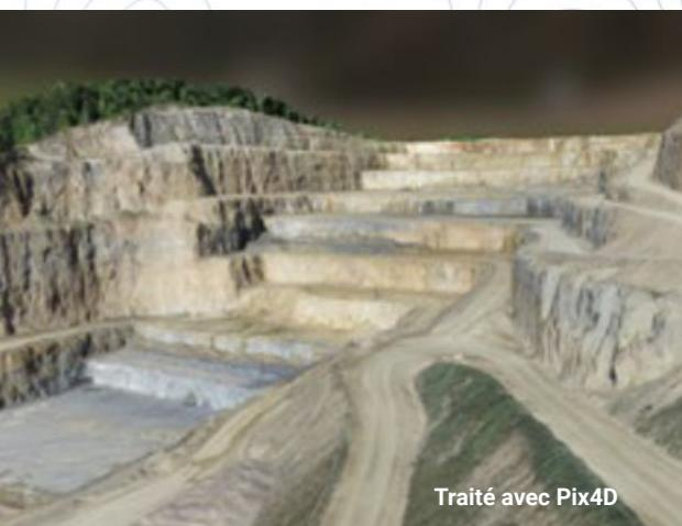
eMotion sadrži Flight Data Manager koji automatski prepoznaje podatke za georeferenciranje i priprema slike za naknadnu obradu aerofotogrametrijskim softverima, kao što je Pix4Dmapper.
