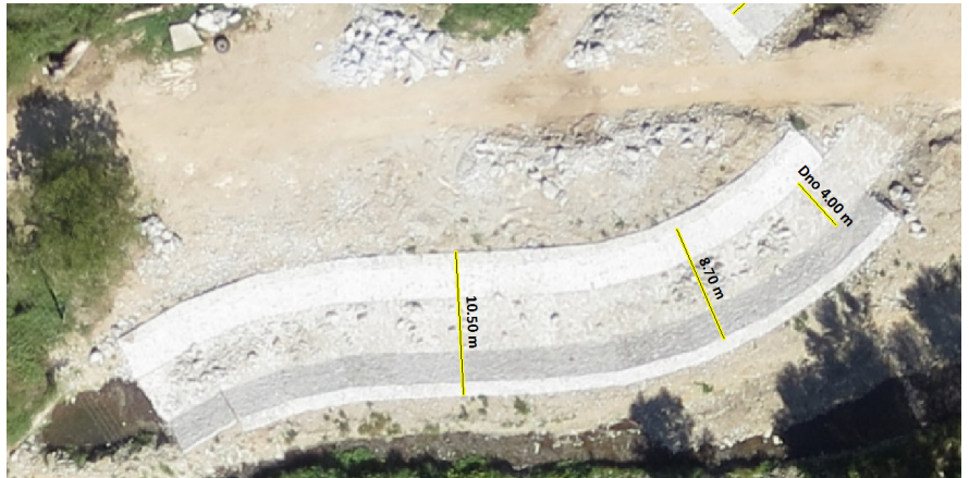
Merenje dimenzija pri uređenju rečnog korita - Koridor 10 - AZVI SA, Grdelica
